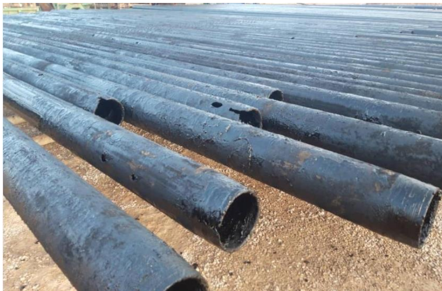
شکل-۲: نمایی از لوله‌های خارج شده از چاه در زمان استقرار دکل، خوردگی شدید در نزدیکی سر لوله (ناحیه رزوه‌ها) قابل مشاهده است.
