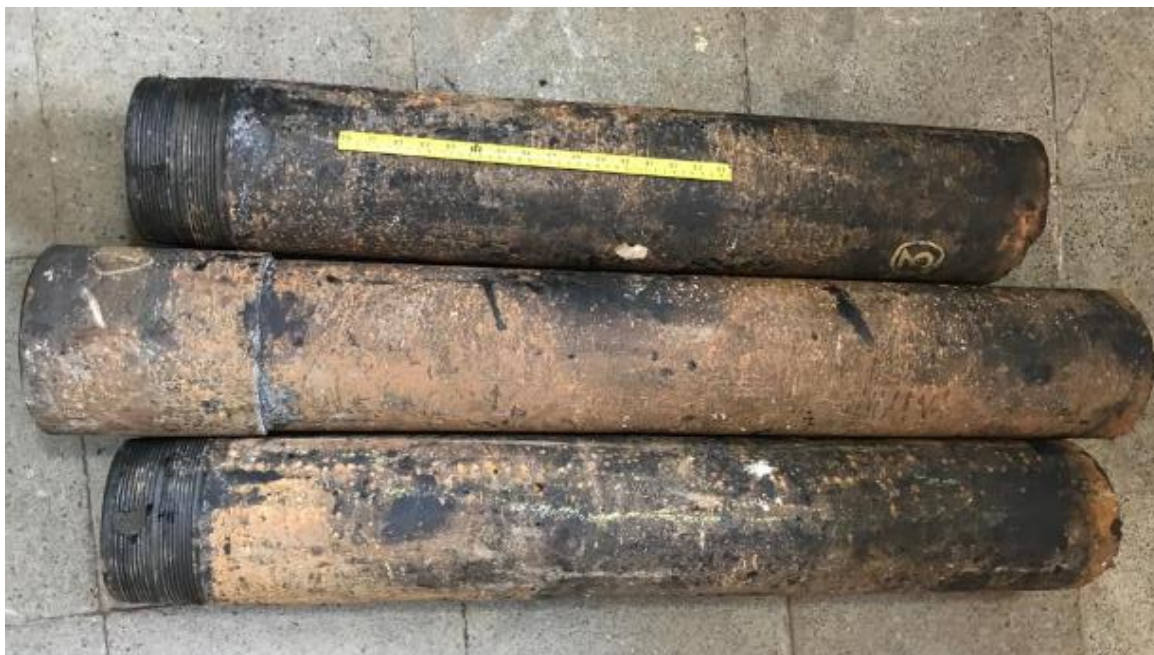
شکل-۴: نمایی از برخی از لوله‌های دریافت شده از چاه تزریقی پساب
