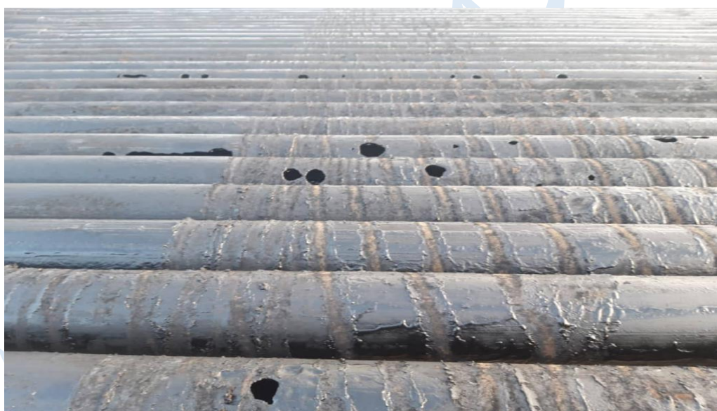
شکل-۳: نمایی دیگر از لوله‌های خارج شده از چاه در زمان استقرار دکل، خوردگی شدید در میانه لوله
