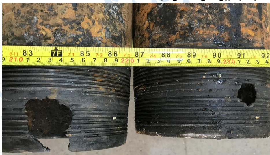
شکل-۵: خوردگی شدید در قسمت رزوه‌های نمونه دریافتی
