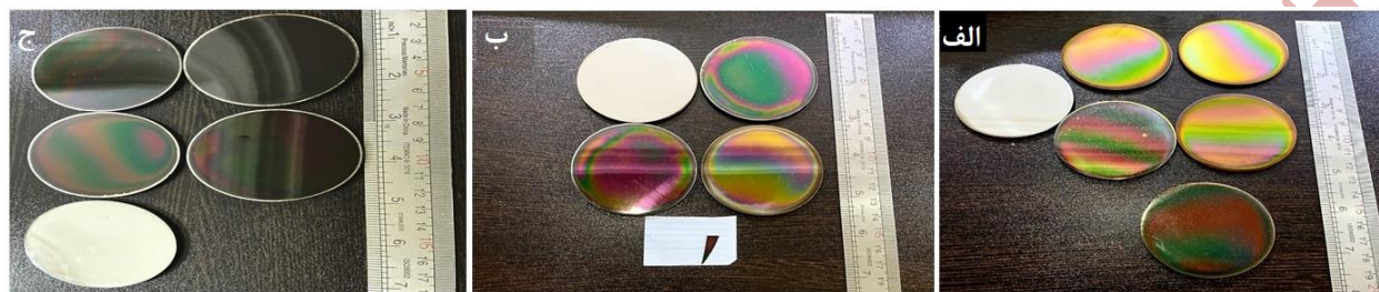
شکل ۲- تصاویری از زیرلایه و پوشش‌های ایجاد شده در هر حالت: الف) Si:DLC 1-Si+ DLC ب) Si:DLC 2-Si+ DLC ج) 3- Si:DLC
