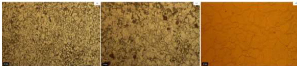
شکل ۱ - ریزساختار فولاد های (الف) IF، (ب) DP590 و (ج) DP980 در بزرگنمایی ۵۰۰x.
