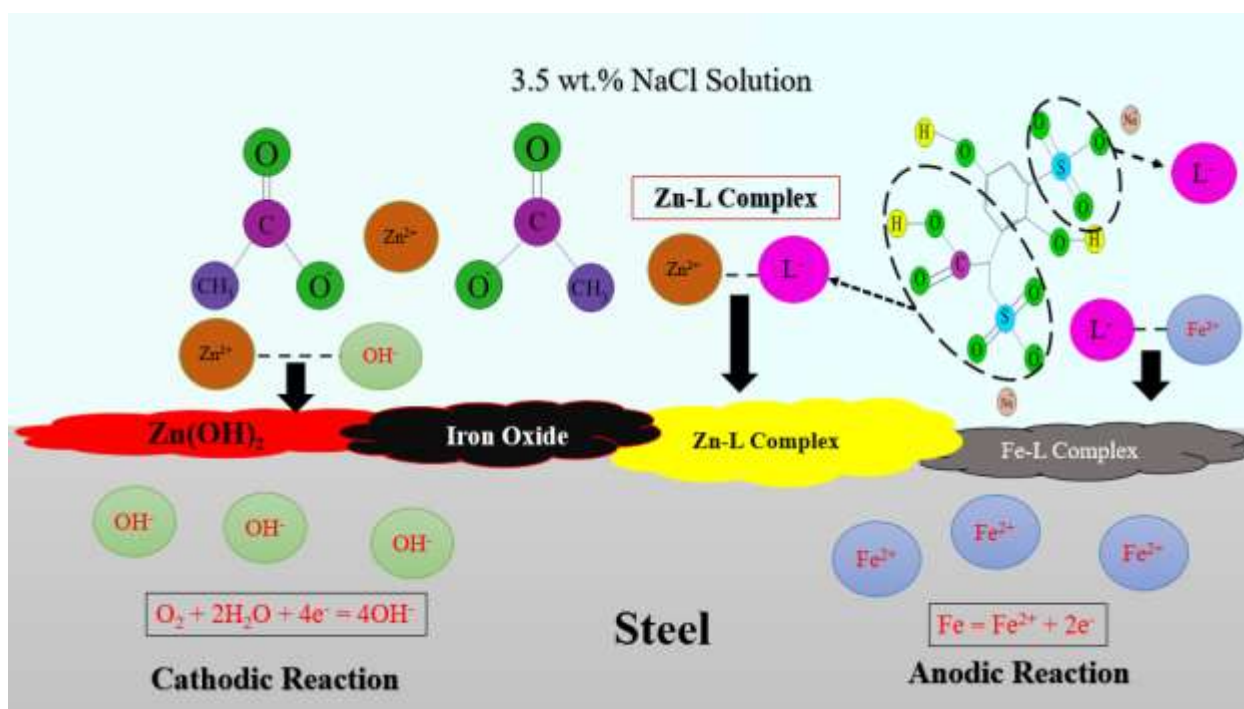
شکل ۷ - تصویر شماتیک حفاظت در برابر خوردگی از سطح زیرلایه فولادی در محلول ۳/۵ wt. NaCl در حضور رنگدانه هیبریدی سنتز شده.
