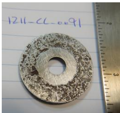
شکل ۱۲ - شکل ظاهری کوپن های پایش خوردگی
