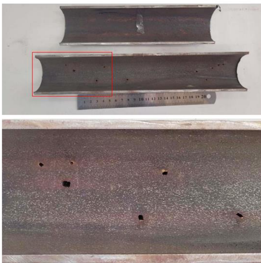
شکل ۳ - سطح داخلی نمونه لوله
