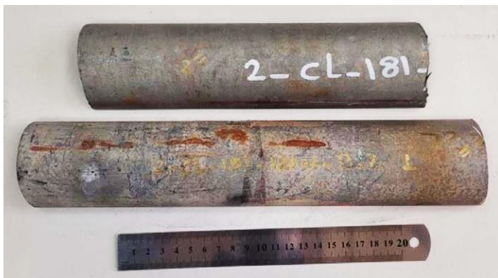
شکل ۲ - سطح خارجی نمونه لوله
