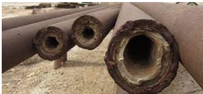
شکل ۱ - تشکیل رسوب در خط لوله [۵]
