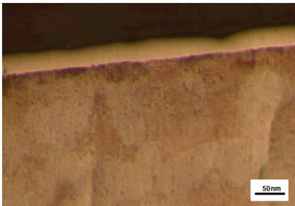
شکل ۲ - تصویر متالوگرافی از سطح مقطع نمونه پوشش‌دهی شده.
