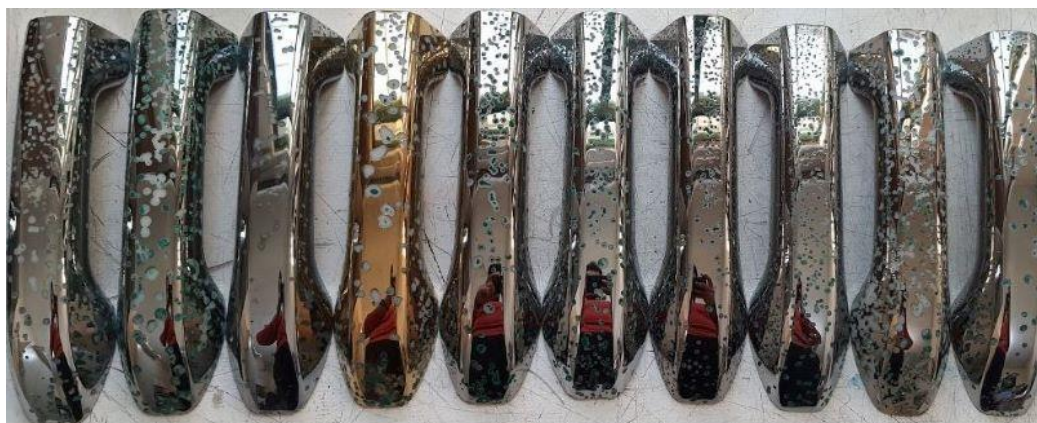
شکل ۴ - نمونه‌های با پوشش آبکاری Ni-Cr با پوشش PVD بعد از آزمون CASS
