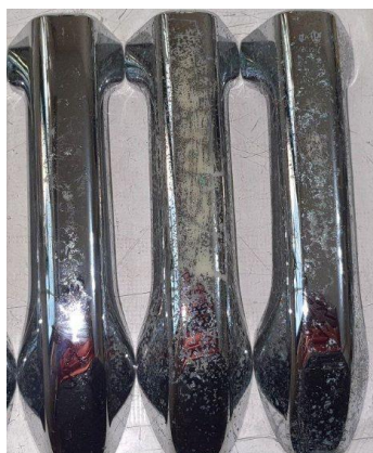
شکل ۳ - نمونه‌های با پوشش آبکاری Ni-Cr بدون پوشش PVD بعد از آزمون CASS
