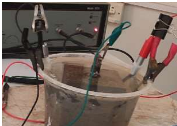
شکل ۱. تصویر سل الکتروشیمیایی جهت اندازه‌گیری امپدانس الکتروشیمیایی و پلاریزاسیون تافل.
