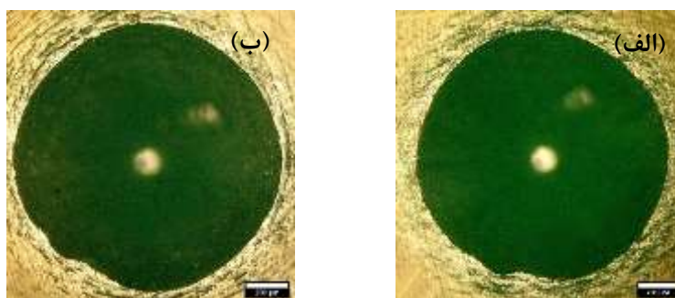
شکل ۱۱. تصاویر میکروسکوپ نوری آزمون راکول برای ارزیابی چسبندگی پوشش آلیاژ آنتروپی بالا AlCoCrFeNi (الف) نمونه A و (ب) نمونه B.
