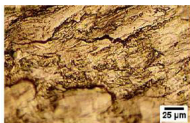
شکل ۱۰ - تصویر میکروسکوپ نوری از سطح نمونه‌های آزمون ترک خوردگی پس از یک ماه غوطه‌وری در محلول آمین رقیق، الف) نمونه‌های بدون پیچ، ب) نمونه‌های پیچ‌دار
