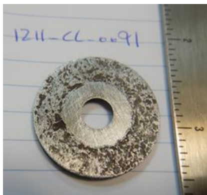
شکل ۱۲ - شکل ظاهری کوپن های پایش خوردگی
