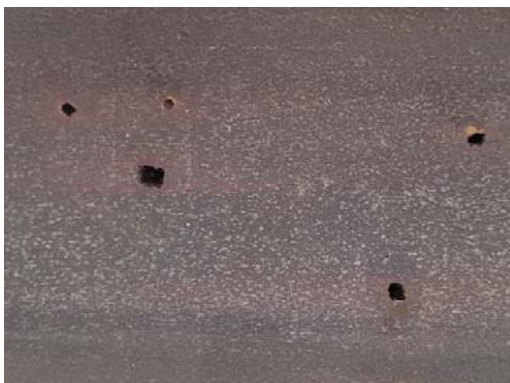
شکل ۱۱ - حفره های ناشی از خوردگی اکسیژنی در نمونه مشابه و مقایسه با نمونه خوردگی حادث شده. سمت راست: حفره های اکسیژنی ایجاد شده در نمونه مشابه در منابع [۶]؛ و سمت چپ: حفره های اکسیژنی ایجاد شده در نمونه مورد بحث در این مقاله.
