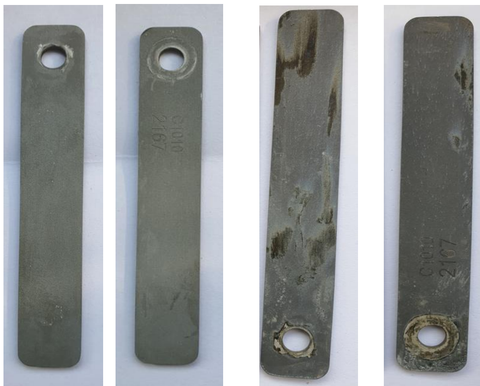
شکل ۱ - تصاویر کوپن‌های ۹۰ روزه خط کولینگ واتر قبل و بعد از تمیزکاری پس از استفاده از مواد با کد A
