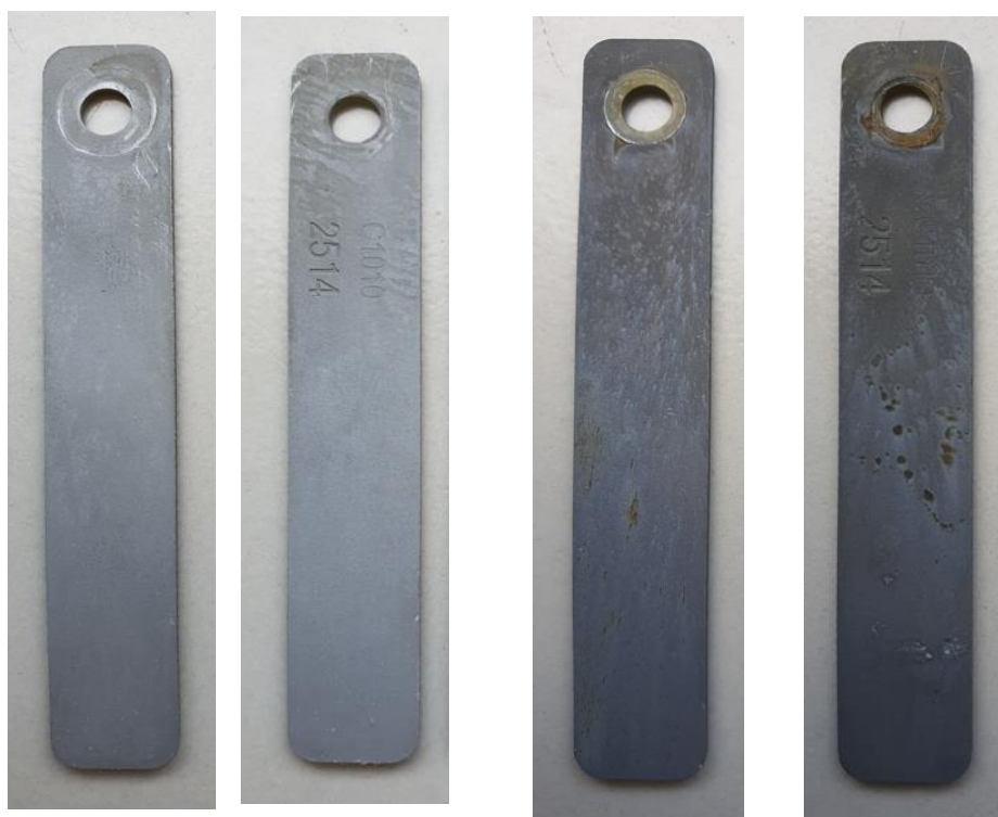
شکل ۲ - تصاویر کوپن‌های ۹۰ روزه خط کولینگ واتر قبل و بعد از تمیزکاری پس از استفاده از مواد با کد B
