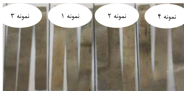
شکل ۴. نمونه کوپن‌های آزمون چرخ دوار در غلظت ۲۵ ppm برای چهار نمونه.
